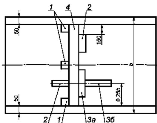
$b$  - ширина проката; 1, 2, 4 - образцы; 3a, 3б - заготовки
